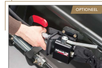
Snelle aansluiting voorlader/werktuig met lekdichte koppelingen dankzij de MACH 20®-stekker. blz. 50
