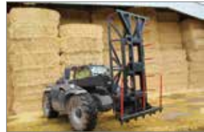
Inklapbaar tandenframe voor een veilig transport.
