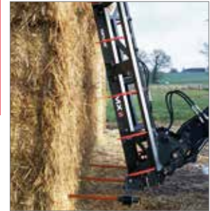
Vast tandenframe zodat de balen makkelijk en veilig kunnen worden losgemaakt.
