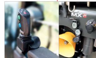
Aansturing met de enkelvoudige joystick van MX:
