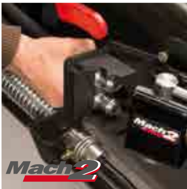
Directe hydraulische aansluiting lader ↔ werktuig
