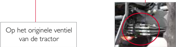
Op het nieuwe hydraulische ven- tiel van MX, bij dubbel effect + permanente zweefstand
