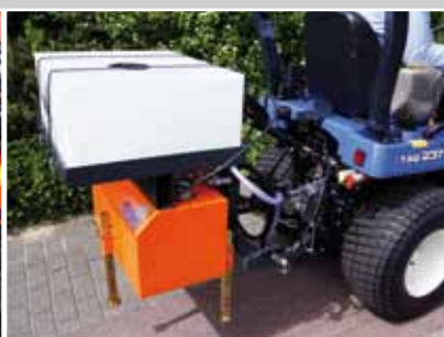
Hydro Drive met watersproeiinrichting
