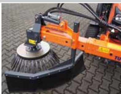
Zijverstelling met hydraulische verstelling hellingshoek
