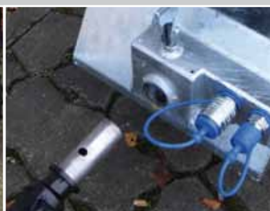
Snelwisselsysteem en DW hydraulikaan-koppeling standaard
