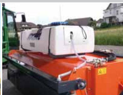
Watersproeinrichting met 100- of 200- liter tank
