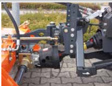
Mechanische aandrijving voor toeren-tallen van 540 tot 2100 toeren/min
