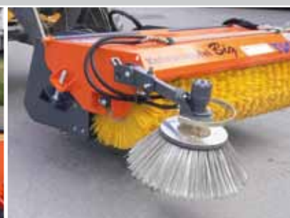
Zijbezem met veerelement (50% PP / 50% staal)
