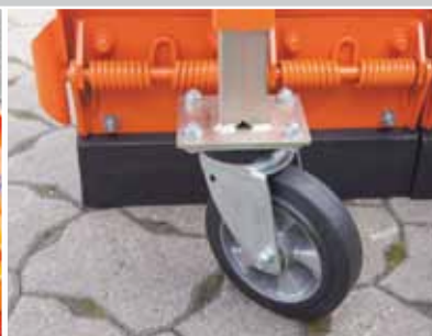
Standaard obstakelbeveiliging (veerklapsysteem)
