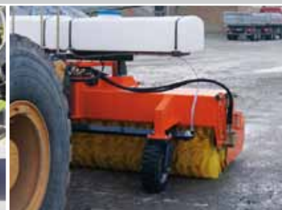
Eenvoudige borstelinstelling met het hevelsysteem
