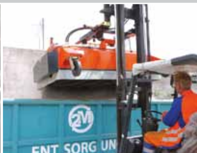
Standaard 3D-niveaucompensatie van het aankoppelsysteem
