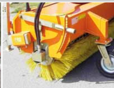
Twee ingebouwde hydromotoren voor de borstelaandrijving
