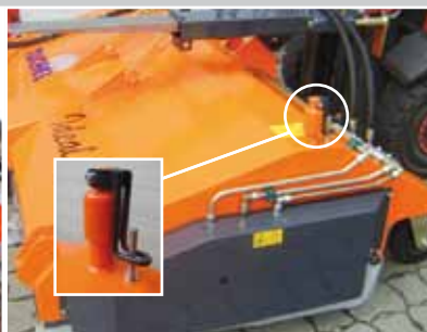
Eenvoudige borstelinstelling van de gependeld opgehangen veegborstel met handslinger
