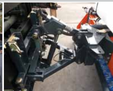
DIN plaat aanbouw met hefinrichting en niveaucom- pensatie
