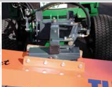
Niveauregeling met hydraulische schuinverstelling
