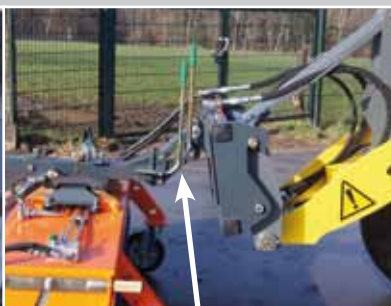
Wielladeropname met parallellogram, en pendelcompensatie en hoogteaankijzing
