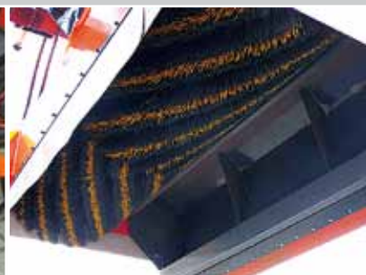
V-vormige speciale veegborstel, voor zowel fijn- als grofvuil
