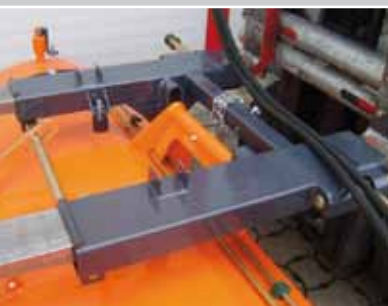
Standaard 3D-niveaucompensatie van het aankoppelsysteem
