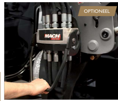
Elektro-hydraulische aansluiting tractor/voorlader met lekdichte koppelingen dankzij het MACH System®. blz. 50
