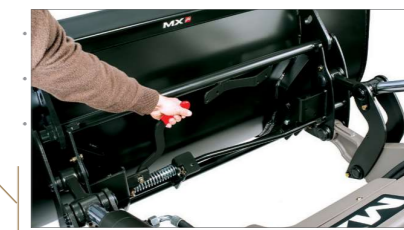
Werktuigframe met automatische vergrendeling. Handvat voor ontgrendeling toegankelijk vanaf de buitenkant.
