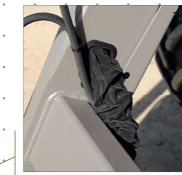
Dubbelbeschermde elektrische bundels in gesloten flexibele behuizing.
