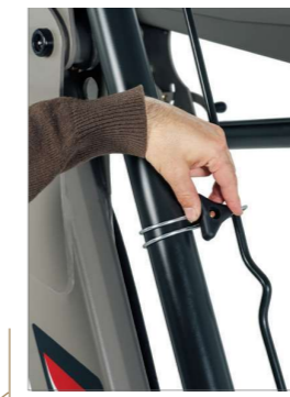
Indicator van de positie van het werktuig
