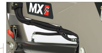
Flexibele leidingen en elektrische bundel in polyurethaan zitten discreet opgeborgen onder de arm van de frontlader. Ze zijn beschermd waardoor ze schoon blijven maar toch goed toegankelijk zijn.
