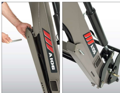
De steunpoten zijn prima geïntegreerd in de arm van de frontlader en kunnen met een eenvoudig systeem worden vergrendeld/ontgrendeld. Ingetrokken vormen zij een carter dat de hydraulische bekabeling beschermt.
