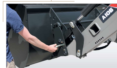
Werktuigframe met automatische vergrendeling. Ontgrendelingshendels toegankelijk aan weerskanten van het werktuigframe.
