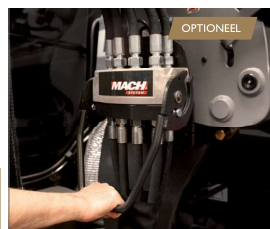
OPTIONEEL Elektro-hydraulische aansluiting tractor/voorzlader met lekkdichte koppelingen dankzij het MACH System®. blz. 50
