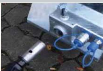
Snelwisselsysteem en DW hydraulikaan-koppeling standaard
