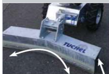
Schuif met dubbele strip incl. niveauregeling en afstandstrips
