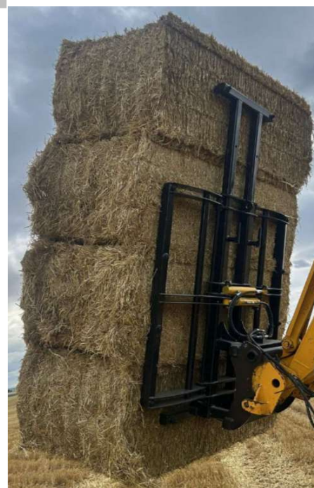
FSK Strokllem met de volgende opties: 2 positioneerbare vorktanden bovenin Opklapbare strovorkbalk onderin
