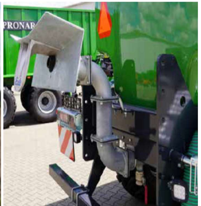
De precisieverdeler "Eisele" met een naar de grond gerichte slagkop maakt een grote spreiding mogelijk, ongeacht de wind
