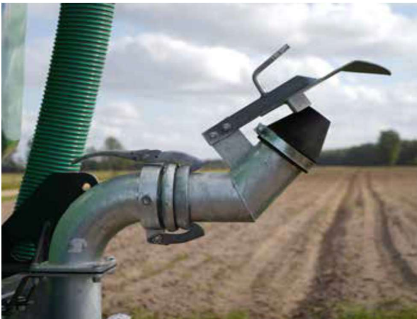
De precisieverdeler "Eisele" met een naar de grond gerichte slagkop maakt een grote spreiding mogelijk, ongeacht de wind
