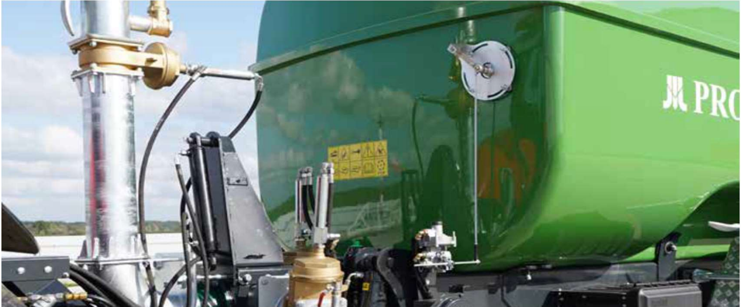
Vatenvulniveau-indicator aangesloten op het ALB-remsysteem als extra veiligheidsmaatregel tijdens het rijden
