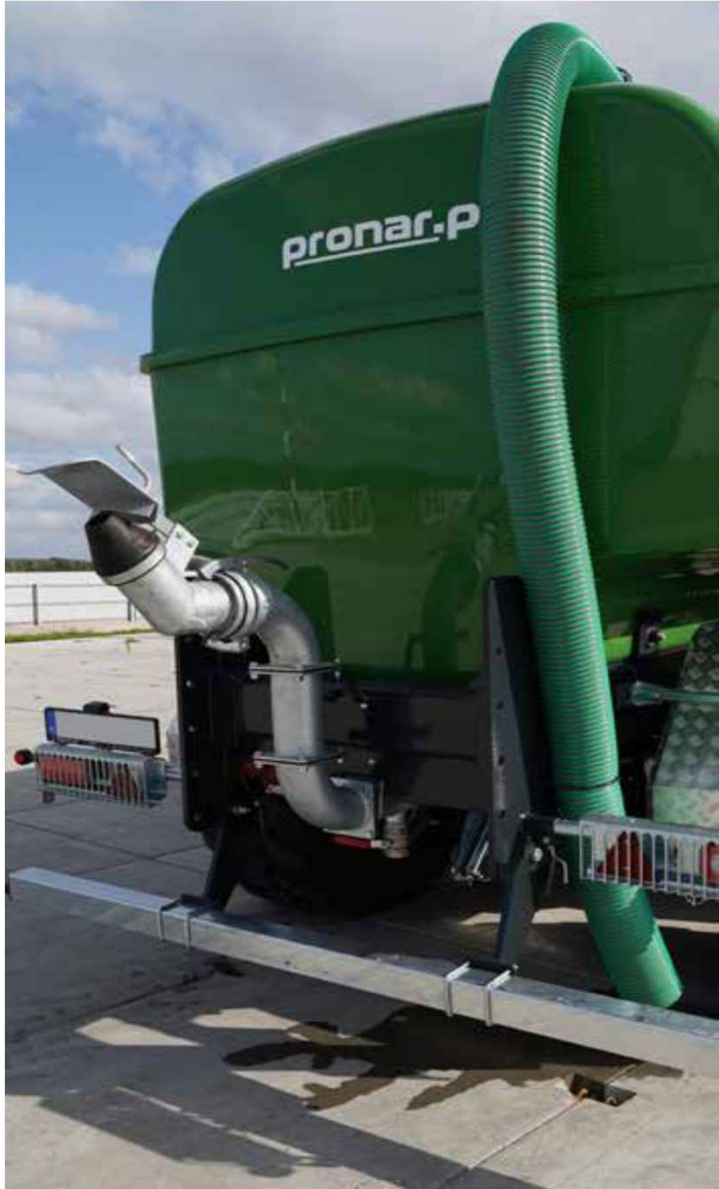
De frameconstructie maakt de bevestiging van een starre en hydraulische montageinstallatie mogelijk
