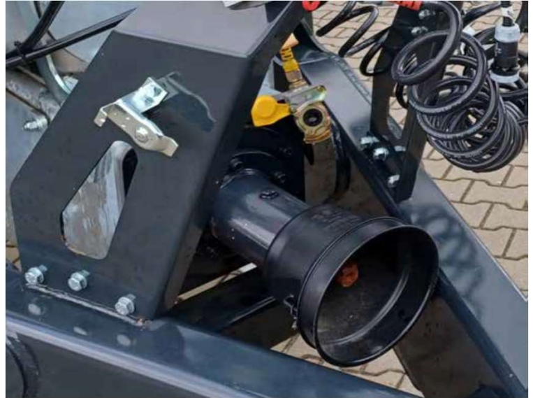
Gelede telescopische as voor het verbinden van de wormpomp met de aftakas van de tractor (540 tpm)
