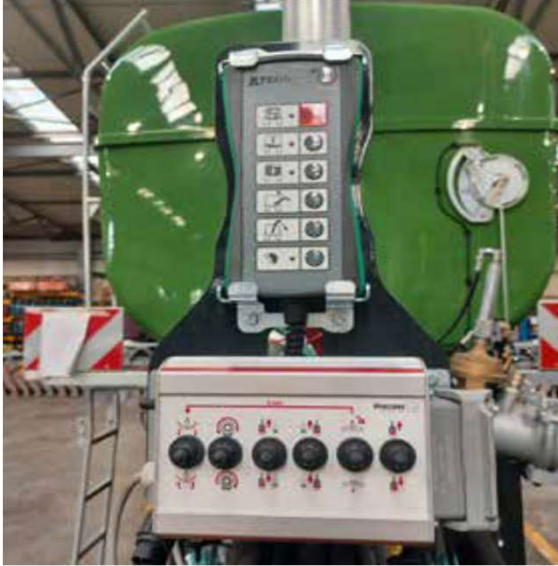
Afstandsbediening voor mesttankwerkzaamheden. Stuurhuis voor externe adapterfuncties
