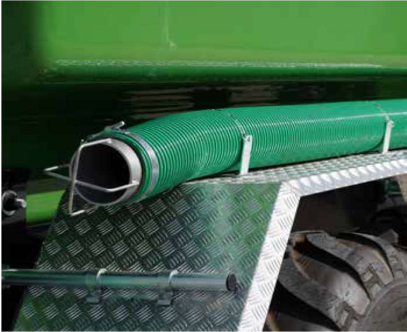
2 x 4 meter lange 6 inch zuigleidingen (Perrot snelkoppelingen) bevinden zich aan beide zijden van het voertuig boven de spatborden
