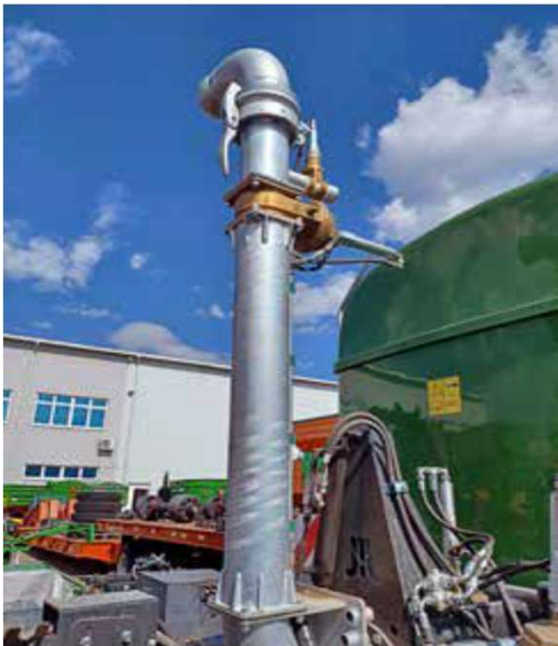
De zuigleiding kan zowel verticaal als horizontaal worden versteld – individueel aangepast aan elke toepassing
