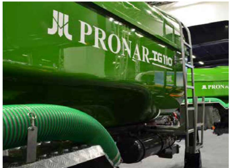
Toegangsladder (inlapbaar) vergemakkelijkt de toegang tot de tankdop
