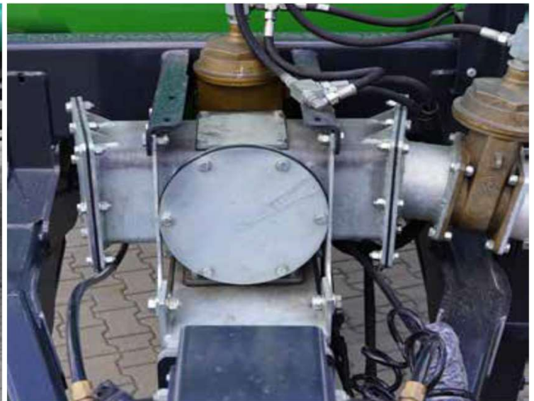
De schroefspindelpomp maakt een vrijwel drukloze werking mogelijk met een hoog rendement, lage schuimvorming en een relatief lager zuigpunt dan bij vacuumpompen
