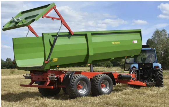
Laadbak met geprofileerde zijkanen, verstevigd met ribben
