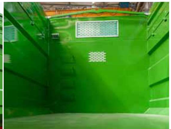
T700XL - Helder PLEXI-venster op de voorwand van de laadbak en zijtreden voor gemakkelijke toegang tot de laadbak
