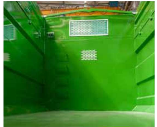
T700XL - Helder PLEXI-venster op de voorwand van de laadbak en zijtrede voor gemakkelijke toegang tot de laadbak
