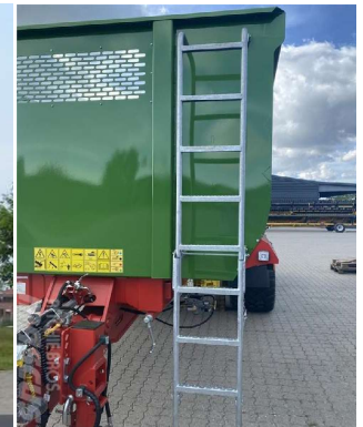
T700M - Ladder die de toegang tot de laadbak vergemakkelijkt
