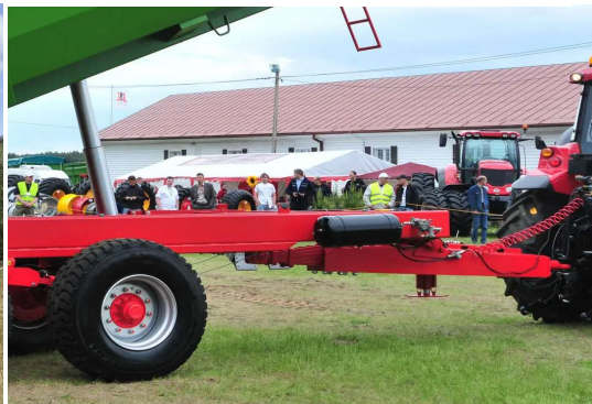
T700 - Universele starre dissel geveerd met verenstalen veer en hoogteverstelling. Mogelijkheid om te koppelen met de onder- of bovenkoppeling van de trekker
